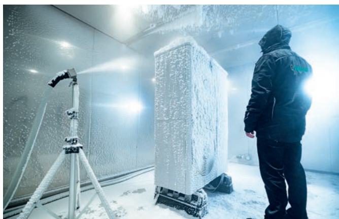
Οι ομάδες δοκιμών λειτουργούν τις μονάδες υπό ακραίες κλιματικές συνθήκες στον κλιματικό θάλαμο.
